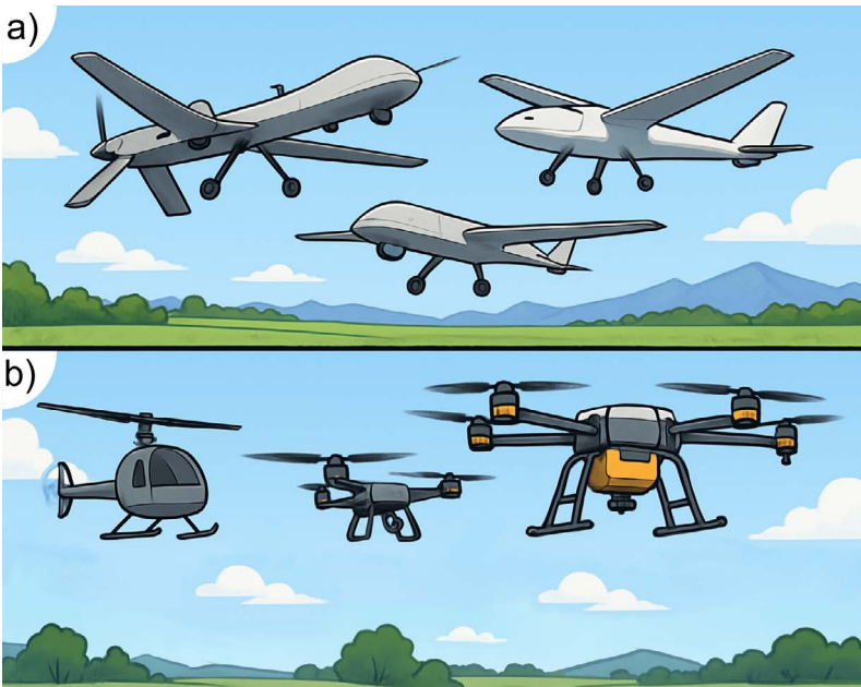
Figura 2 — Modelos de drone: a) Asa fixa; b) Asa rotativa
