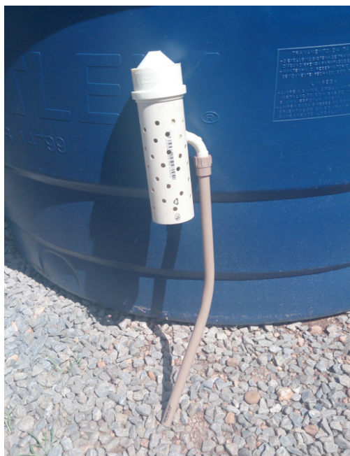
Figura 7 – Abrigo termométrico utilizado nas medições móveis
