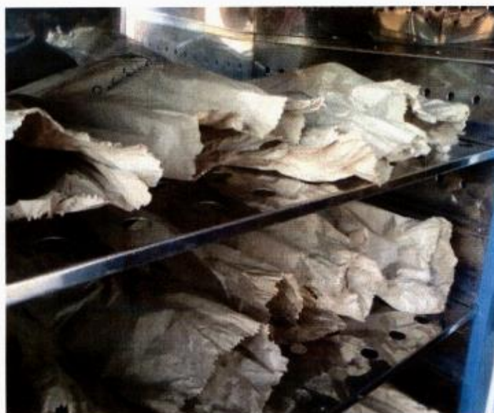
Figura 5 Secagem do capim Marandu em estufa de circulação forçada à 65^\circ\text{C} .
