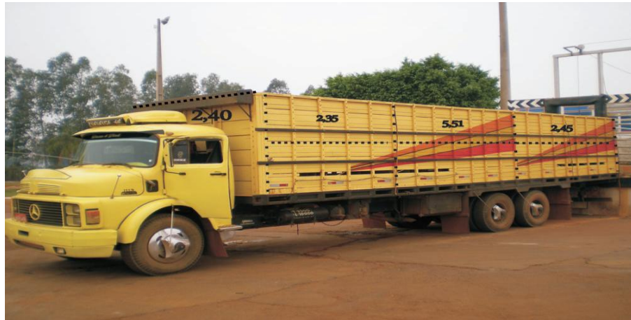
Figura 4: Veículo não articulado com três eixos, conhecido como caminhão truck Fonte: PARANHOS DA COSTA et al., (2010).
