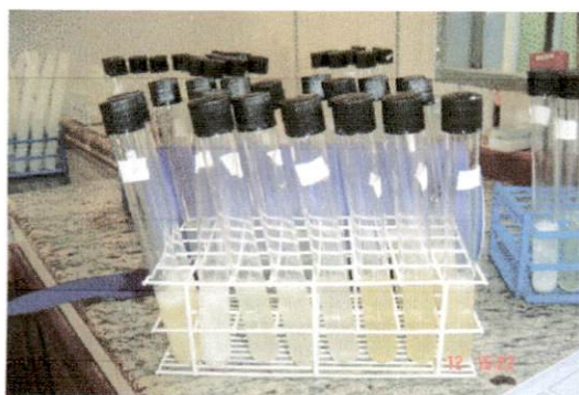
Fig. 3 Tubos de Duhran utilizados na análise de Coliformes
