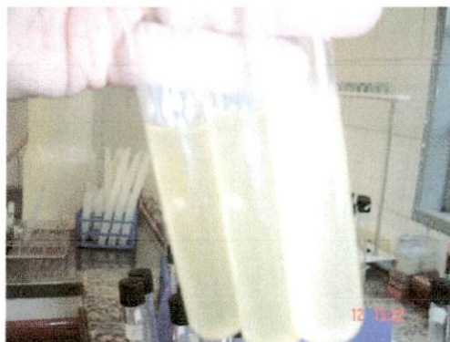
Fig. 2 Formação de gases em meio de cultura caldo lactosado, provocado por coliformes fecais
