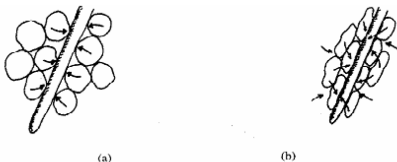
Figura3: Solo antes (a) e solo depois de compactado (b), mostrando a redução dos poros maiores em poros menores. Fonte: Resende et al. (1997).
