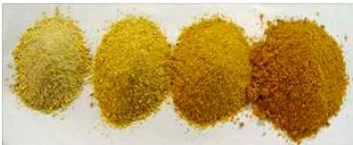
Figura 3 - Diferentes colorações do GSDS, ocasionado pelo excesso de calor no momento da desidratação (secagem).
