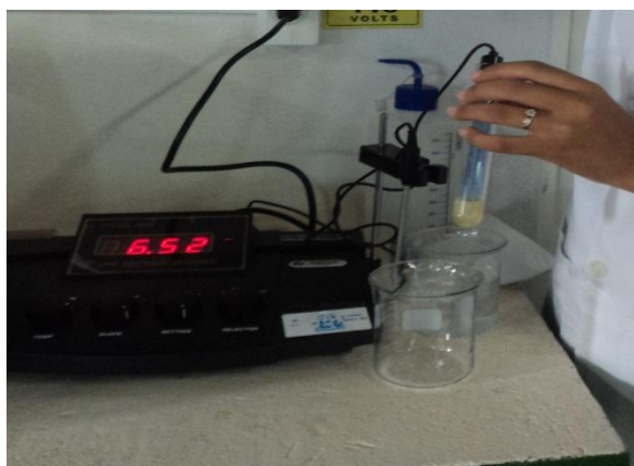
Figura 5- Mensuração do pH da gema do ovo de codornas alimentadas com diferentes níveis de raspa de mandioca integral desidratada (RMID), no pHmetro.
