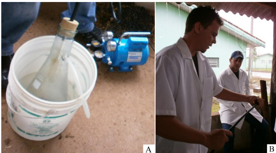
Figura 2: Kitassato instalado na bomba de sucção e mantido em recipiente contendo água morna (A); Lubrificação da sonda, utilizando óleo mineral, antes de iniciar as atividades de coleta (B).
