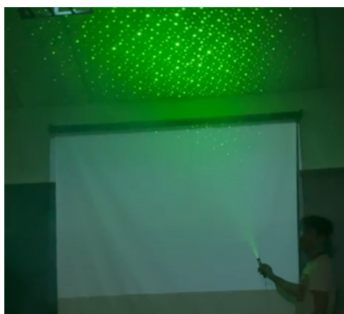
Figura 5 - Uso de um laser verde com múltiplos feixes mostrado depois de esfumaçar a sala para permitir uma melhor visualização dos feixes de luz. Com essa abordagem foi possível discutir reflexão em espelhos planos e curvos e refração (conceito por trás das lentes de óculos)
