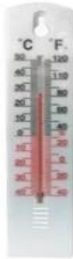
Figura 6- Termômetro ambiente tipo taco utilizado para mensurar temperatura ambiente.
