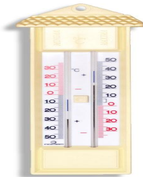
Figura 8 - Termômetro de máxima e mínima tipo capela utilizado para obter as variações das temperaturas ocorridas.
