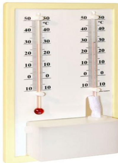
Figura 7 - Termômetro de bulbo seco e úmido utilizado para obter porcentual da umidade relativa do ar.
