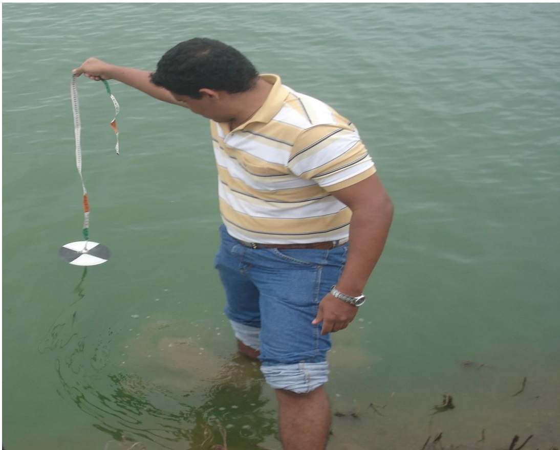
Figura 4: Medição da transparência da água com disco de Secchi.
