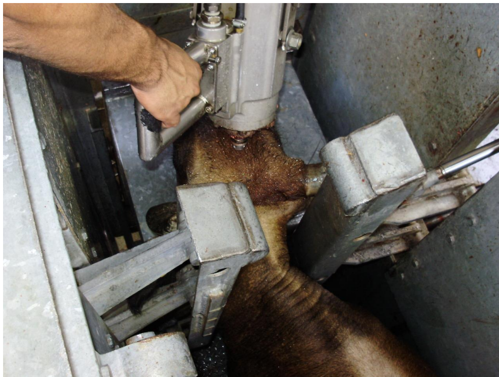
Figura 3: Pistola pneumática, momento antes da insensibilização do animal Fonte: Autor (2009)
