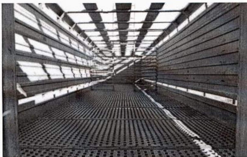
Figura 2. Paredes do caminhão não podem ter pontas de prego, parafusos ou lascas de madeira que possam causar lesões no gado, e com pisos antiderrapantes. Fonte: Tuba (2012).
