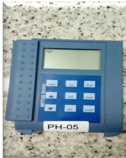
Figura 5: pHmetro portátil da marca Mettler Toledo utilizado nas aferições dos pHs dos animais avaliados.
