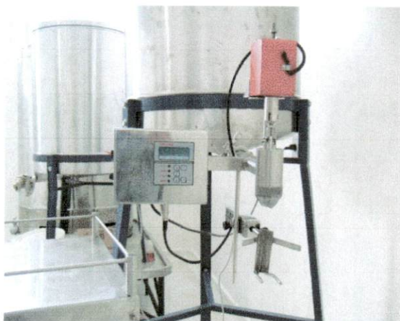
Fig. 14. Decantador com balança eletrônica.
