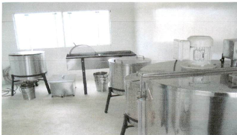
Fig. 04. Centrífuga, mesa desoperculadora, filtro e baldes.
