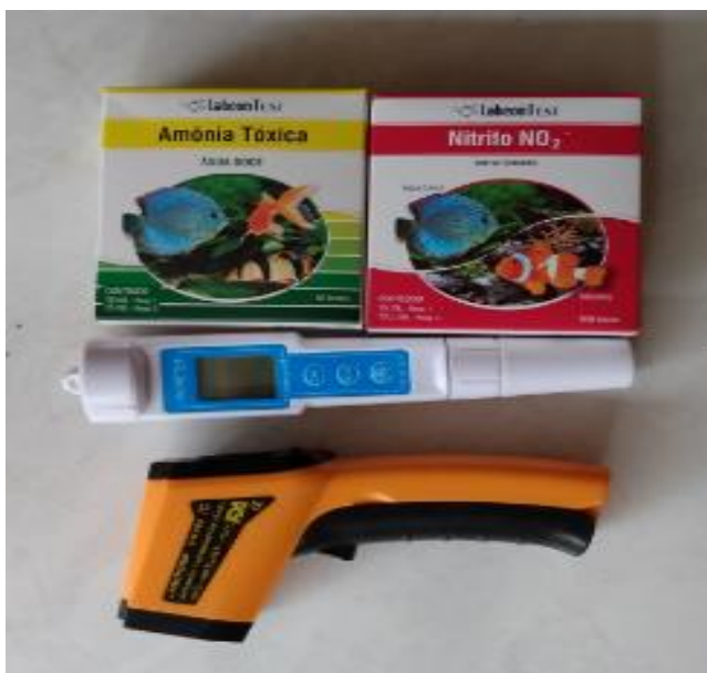
Figura 7 – Kits de análises comerciais de amônia e nitrito, e medidor digital de temperatura e pH.
