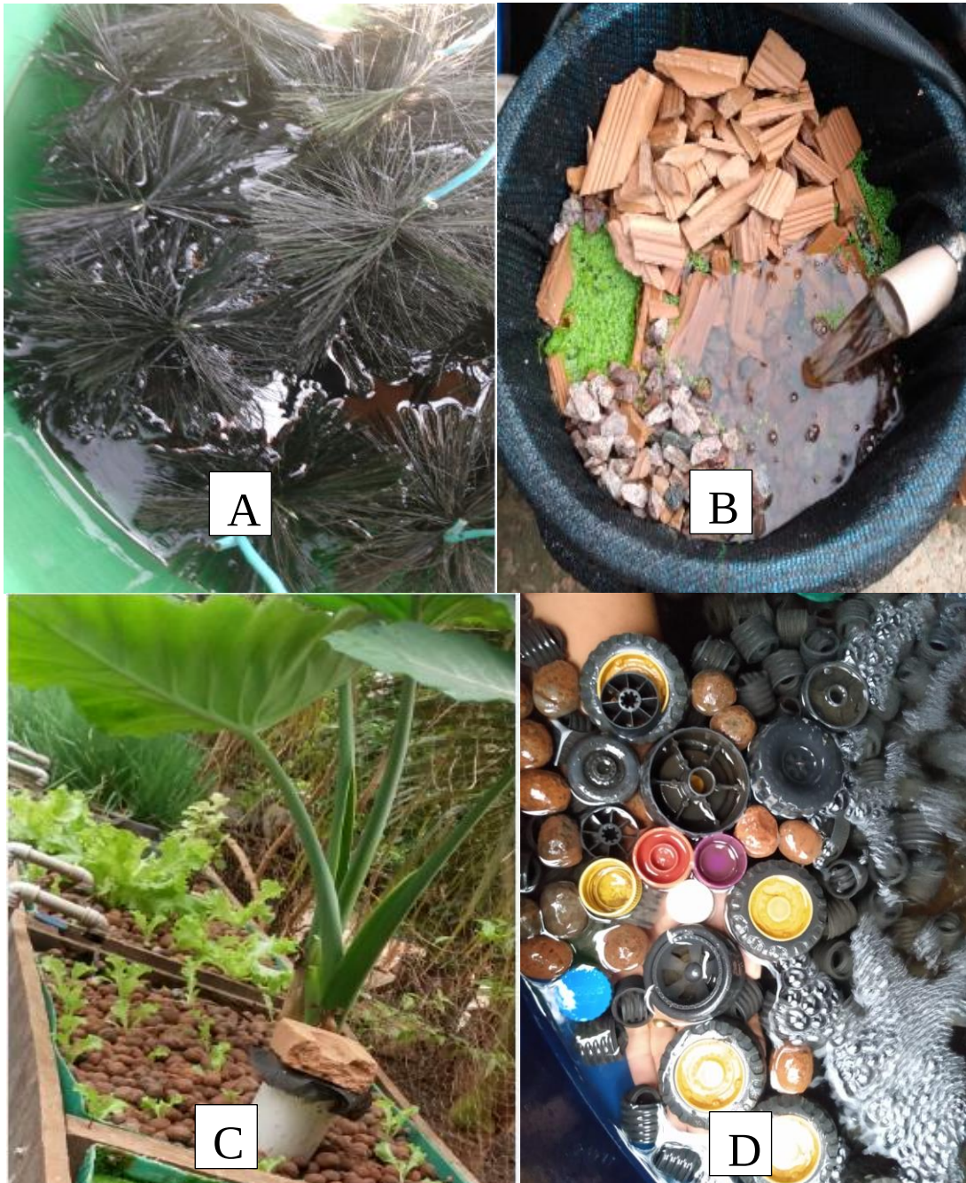
Figura 10 – Equipamentos e materiais utilizados como filtro biológico na propriedade: (A) escova filtrante biológica, (B) pedaços de tijolos com pedra brita, (C) argila expandida também utilizada para cultivo de espécies vegetais como a taioba e alface (D) filtro com diferentes tipos de objetos para fixação das bactérias como mídias biológica alfa MBBR, eletroduto corrugado, tampas de garrafas plásticas e rodas de carrinhos de brinquedo.
