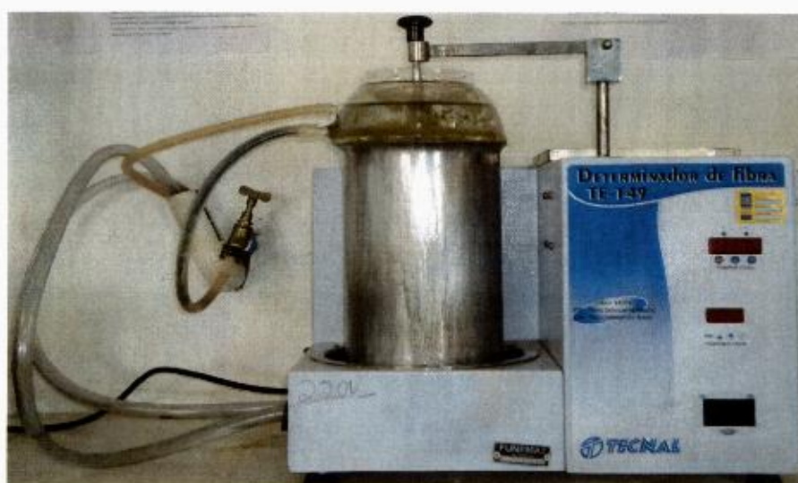
Figura 2. Determinador de fibra em detergente neutro - FDN e fibra em detergente ácido - FDA, Modelo TE-149 (Tecnal®) semelhante a Ankom® .
