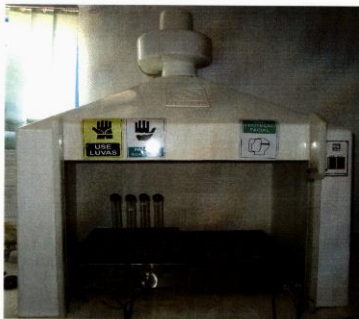
Figura 3. Bloco digestor utilizado como chapa aquecedora para a determinação do teor de fibra em detergente neutro – FDN e fibra em detergente ácido – FDA pelo método EMBRAPA.
