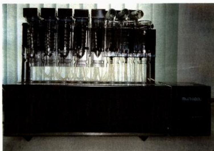
Figura 1. Determinador de fibra convencional, utilizado para obtenção do teor de fibra em detergente neutro - FDN; fibra em detergente ácido - FDA e fibra bruta - FB pelo método convencional de Van Soest, modelo MA 455/850, marca Marconi®.
