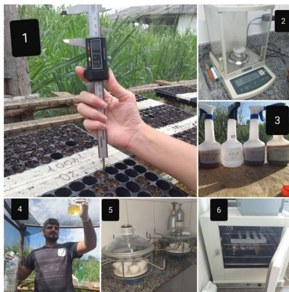
Figura 3 – Materiais utilizados: 1- Paquímetro, Substrato, Bandeja; 2- Balança; 3- Borrifador; 4- Becker de vidro; 5- Dessecador e Cadinho de Porcelana; 6- Estufa.
