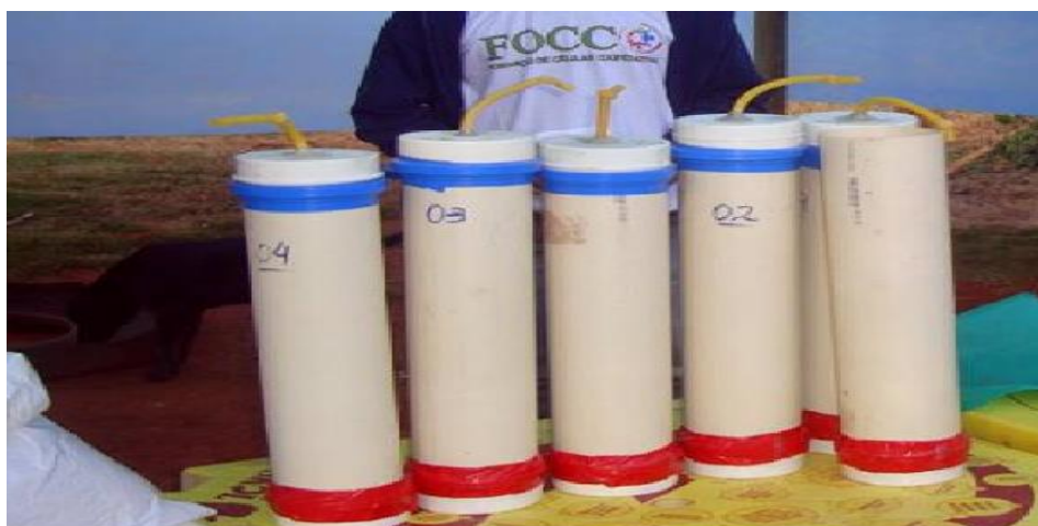
Figura 4 - Tubos de PVC, com vedação superior e inferior e válvula para expulsão de gases.
