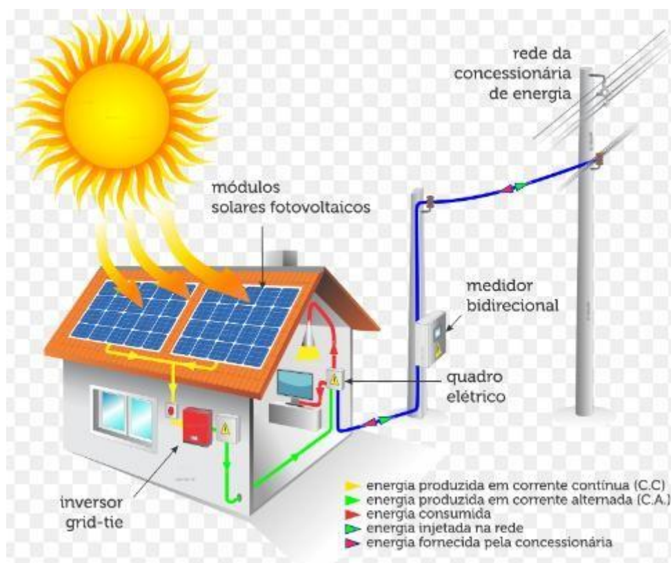
Figura 12 - Sistema Fotovoltaico conectado à rede
