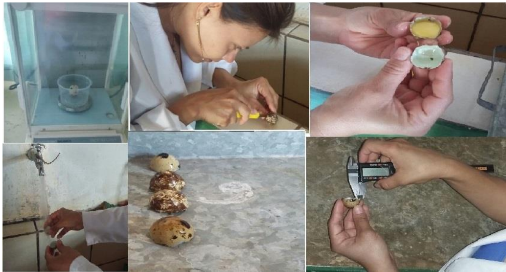
Figura 4 – A figura ilustra o momento da pesagem o ovo, do corte, da lavagem, a secagem e a medição da espessura da casca através do paquímetro.
