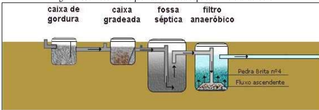
Figura 163. Desenho esquemático fossa séptica e filtro anaeróbico
