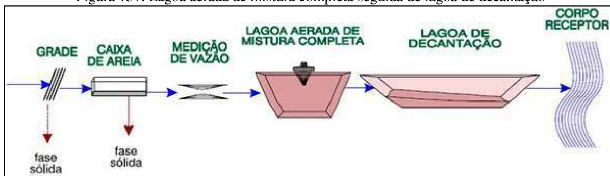
Figura 157. Lagoa aerada de mistura completa seguida de lagoa de decantação
