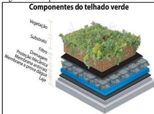
Figura 170. Esquema construtivo de telhado verde
