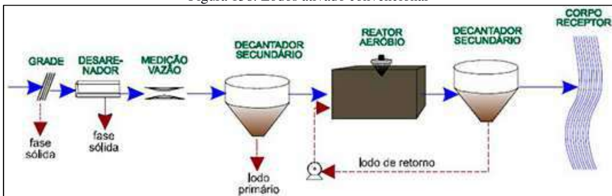
Figura 158. Lodos ativado convencional
