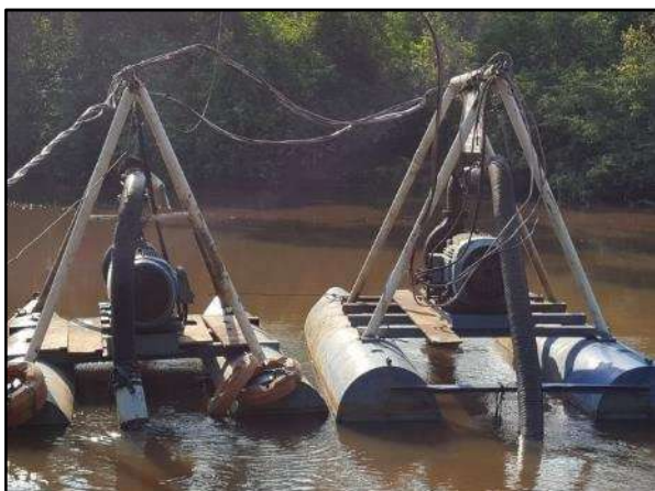
Figura 14. Mangotes flexíveis com diâmetro de 200 mm
