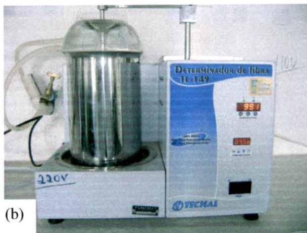
Figura 7 - Processo de destilação da fração nitrogenada da silagem (a) e determinação da fibra em detergente neutro (b).
