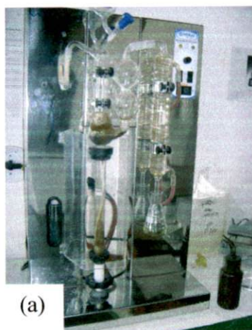
Figura 7 - Processo de destilação da fração nitrogenada da silagem (a) e determinação da fibra em detergente neutro (b).
