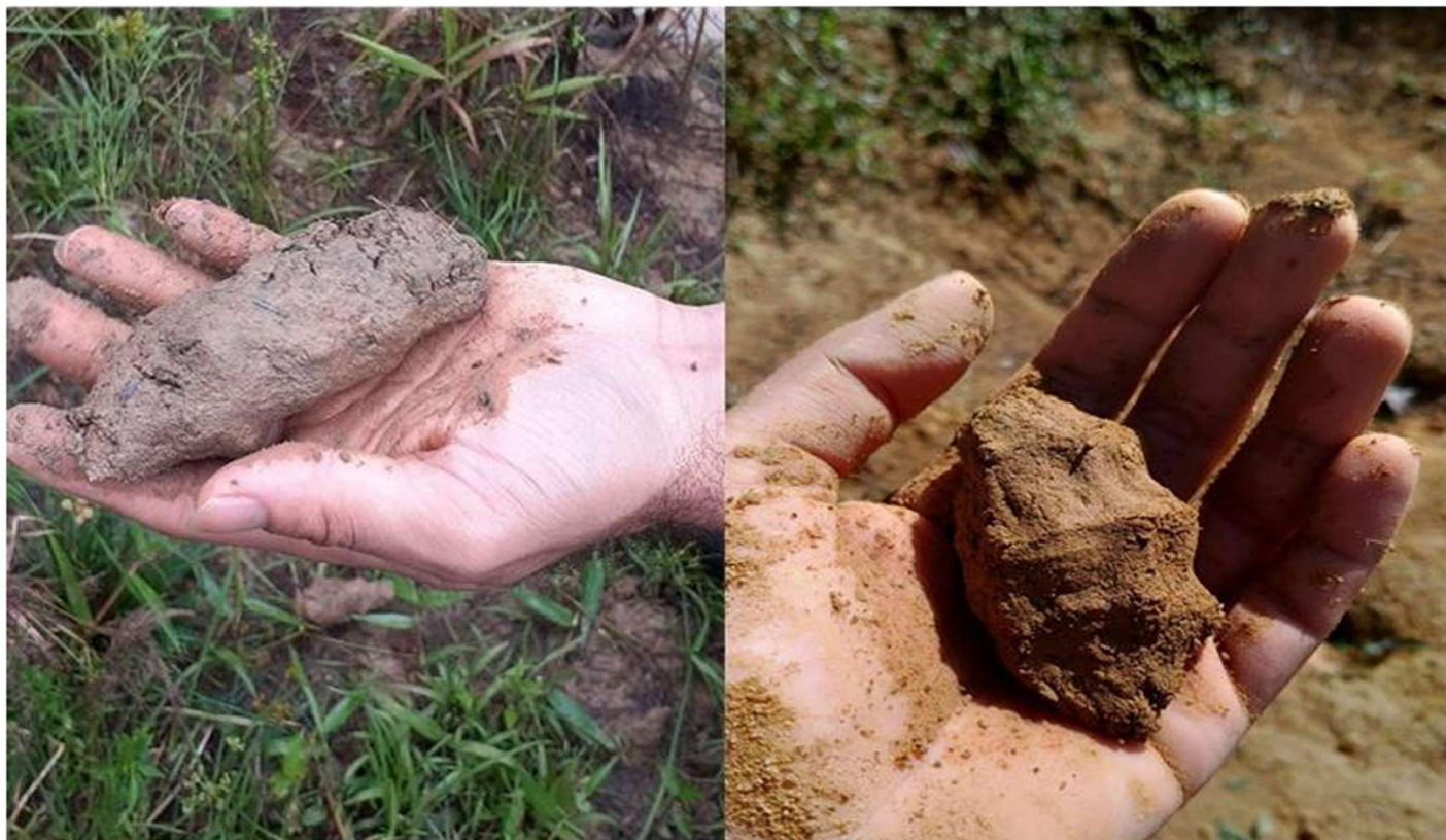
Figura 13: Teste de Mão para identificar, em campo, a umidade apropriada para conformação de solos. Foto da esquerda Fazenda de Pacotuba - ES; Foto da direita Fazenda da Marilândia - ES. Fonte INCAPER, 2021.
