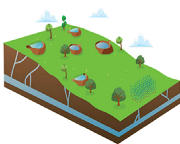
Figura 6 – Sistema mostrando barraginhas no topo e no meio da encosta, ajudando a segurar a água da chuva e diminuir a força da enxurrada. Fonte: REM SEMA.
