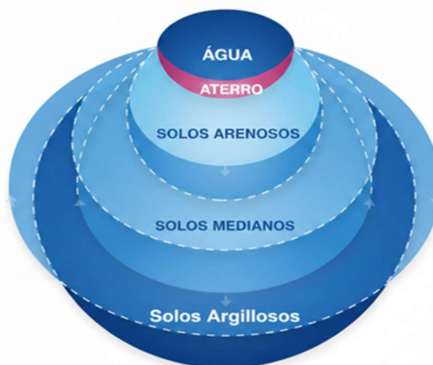
Figura 11 – Esquema mostrando que a água infiltra mais rápido em solos arenosos, de forma média nos solos medianos e mais devagar nos solos argilosos. Adaptado de BARROS, 2026.
