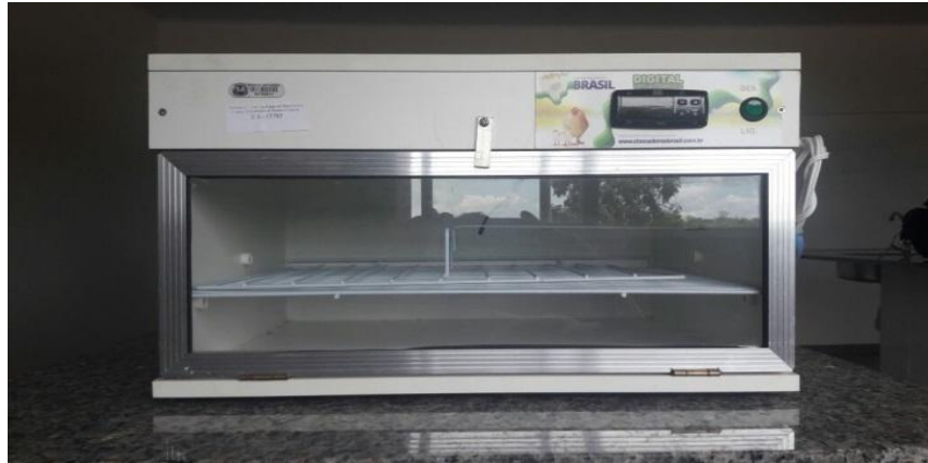
Figura 4 - Chocadeira automática da marca chocadeira Brasil, Modelo CB 52. Fonte: Arquivo pessoal.
