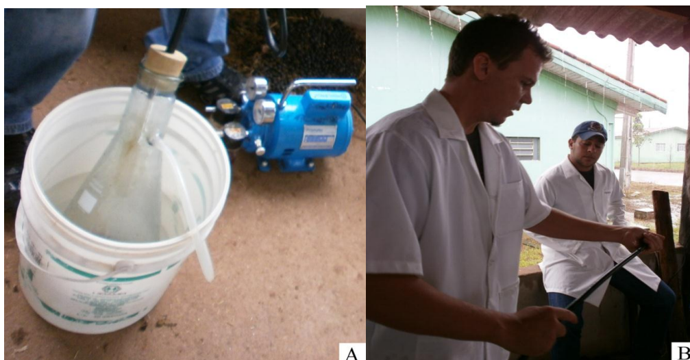
Figura 2: Kitassato instalado na bomba de sucção e mantido em recipiente contendo água morna (A); Lubrificação utilizando óleo mineral, antes de iniciar as atividades de coleta do líquido ruminal (B)
