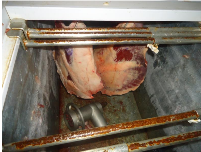
Figura 8: Ferrugem no freezer de mercado pequeno.
