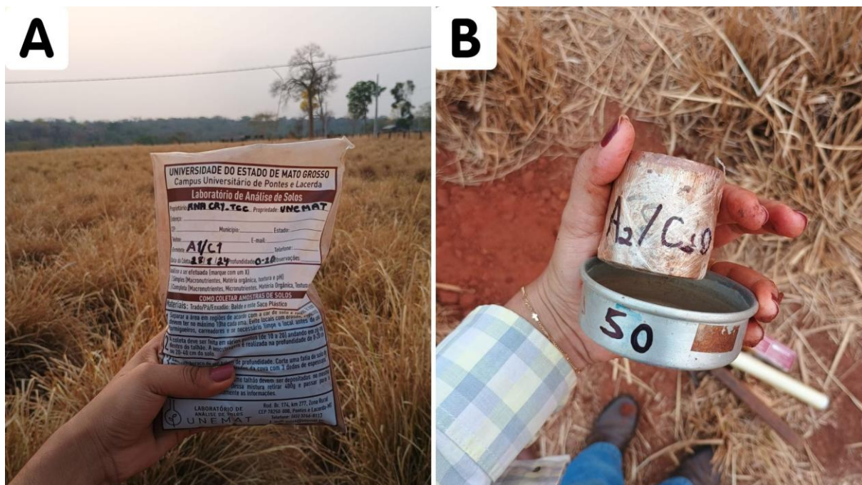
Figura 5: A) amostra deformada, com sua devida identificação; B) amostra indeformada, utilizando anel volumétrico, devidamente identificado.
