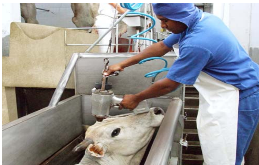
Figura 10. Equipamento de atordoamento, marreta pneumática, com pino retrátil. (Fonte:Fribrasil, 2008)
