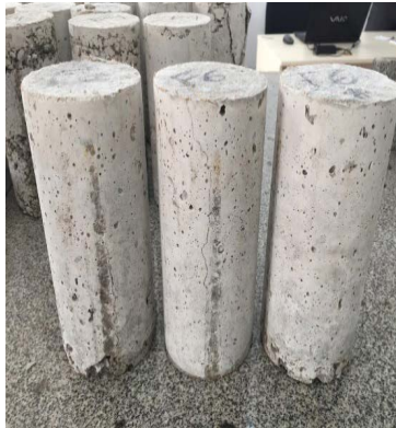
Figura 5d – Fissuração dos corpos de prova no ensaio de compressão à tração por compressão diametral: Traço com 6% de adição
