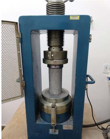
Figura 3a – Ensaio resistência à compressão axial
