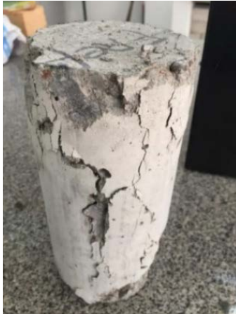
Figura 4a – Fissuração dos corpos de prova no ensaio de compressão axial: Traço referência
