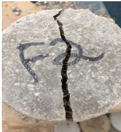
Figura 5b – Fissuração dos corpos de prova no ensaio de compressão à tração por compressão diametral: Traço com 2% de adição
