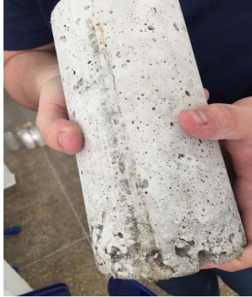
Figura 5c – Fissuração dos corpos de prova no ensaio de compressão à tração por compressão diametral: Traço com 4% de adição
