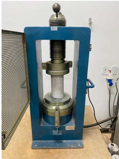
Figura 1 – Prensa elétrica com corpo de prova posicionado
