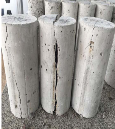
Figura 5a – Fissuração dos corpos de prova no ensaio de compressão à tração por compressão diametral: Traço referência
