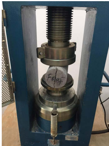
Figura 3b – Ensaio resistência à tração por compressão diametral
