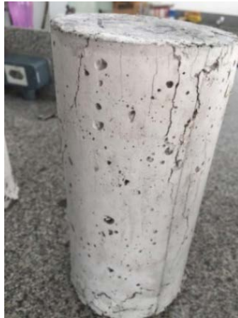
Figura 4b – Fissuração dos corpos de prova no ensaio de compressão axial: Traço com 2% de adição
