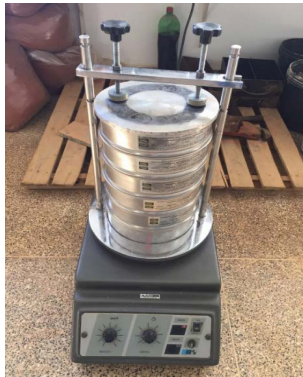
Figura 1 – Conjunto de peneiras no agitador mecânico para ensaio de granulometria
