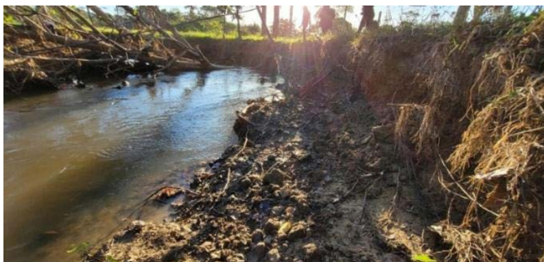
Figura 39 – Erosão e recuo marginal de 1,18 m, verificado na seção 9B
