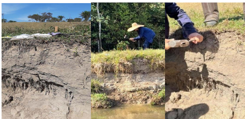
Figura 9 – Instrumentalização das margens através do método de pinos e estacas
