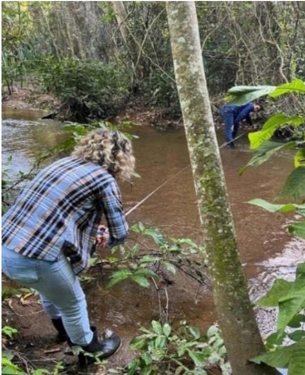
Figura 7 – Quantificação da largura do córrego Mineiro
